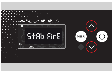
StAb FirE A salamandra está estabilizando após atingir a temperatura mínima para ser considerada acesa. A resistência elétrica se apaga. No display, o led do extrator de fumaça e alternadamente o da coclea acende.
