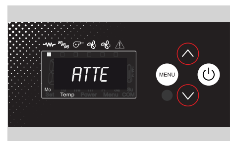
AttE Aparece quando é feita uma tentativa de reiniciar a salamandra enquanto um ciclo de resfriamento está em andamento. Aguarde o ciclo de desligamento terminar, limpe o braseiro e prossiga com uma nova ignição.
