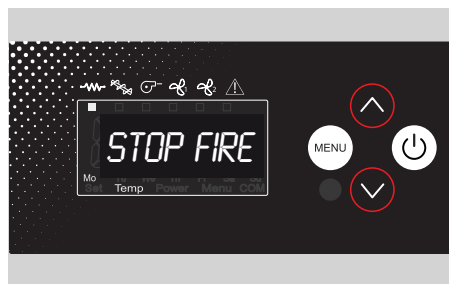
Stop FirE La estufa está en la fase de limpieza del brasero. El extractor de humos funciona al máximo.
