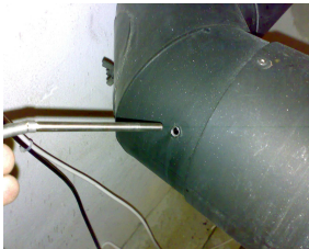
Røgføler monteres i et 6,5 mm hul i røgrør.
