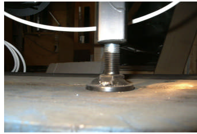
Husk at justere støtteben til magasin Således at kedel og magasin står i vatter
