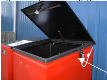
Husk at ledning til sikkerheds afbryder skal monteres korrekt.
