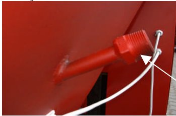
Studs til montering af brandsluknings ventil.
